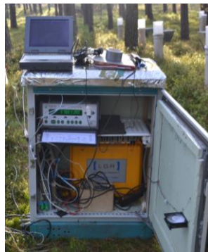
Abb. 2: Analysesystem zur CH 4 , N 2 O & CO 2 Bestimmung
